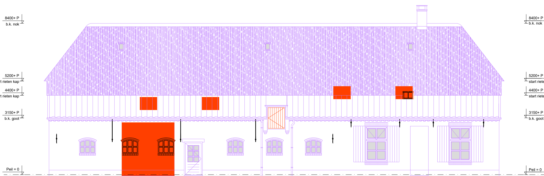
LINKER ZIJGEVEL - slooptekening Fysiek te behouden bij renovatie ■ Te behouden ■ Mogelijk te behouden ■ Te amoveren
