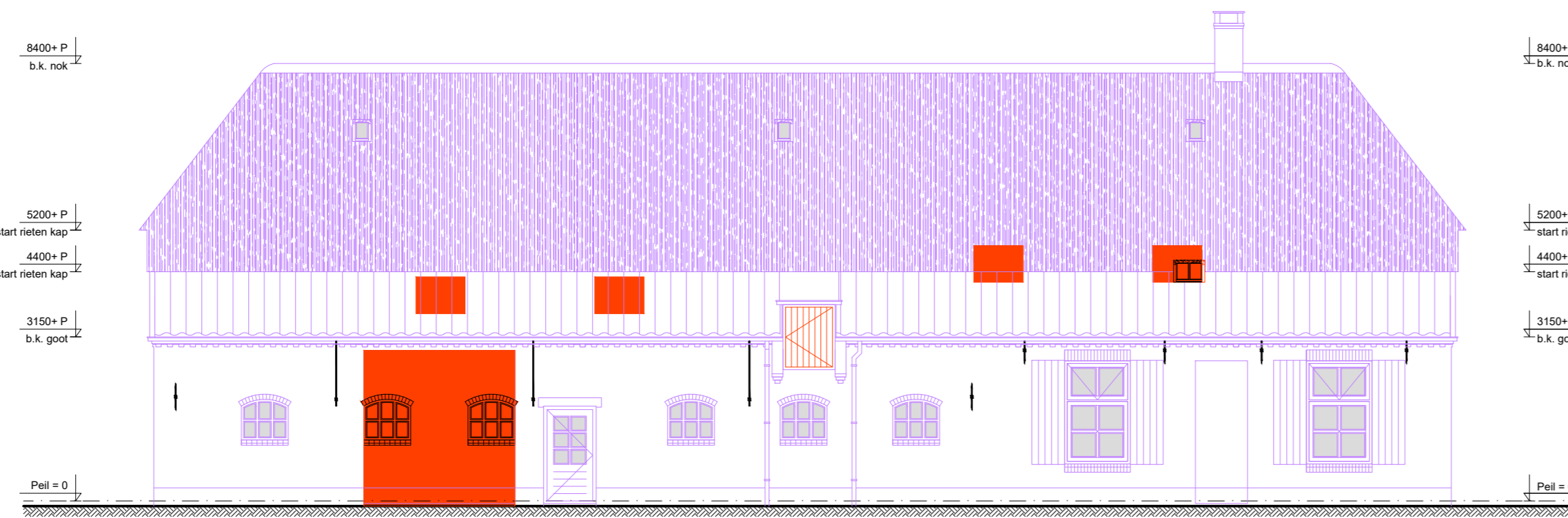
LINKER ZIJGEVEL - slooptekening Fysiek te behouden bij renovatie (purple) Te behouden (blue) Mogelijk te behouden (green) Te amoveren (red)
