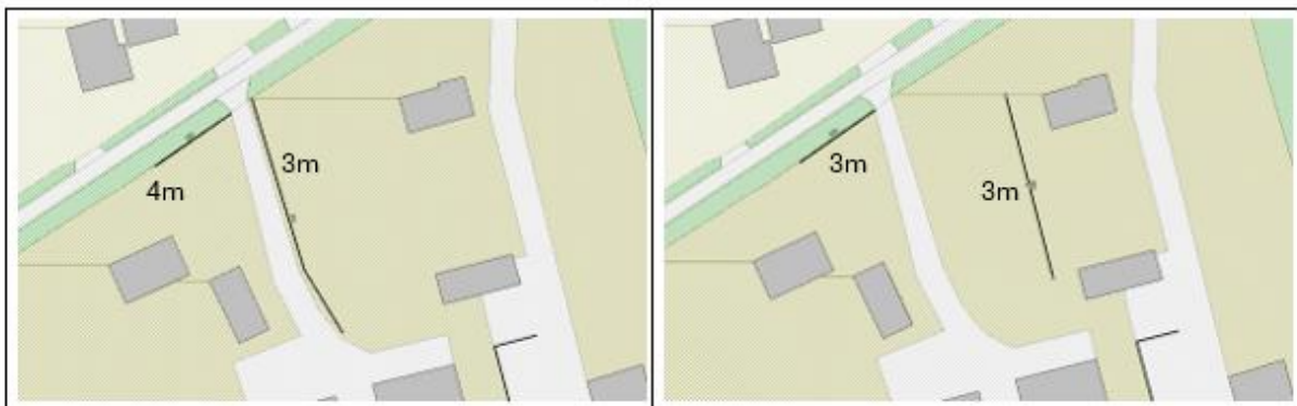
Twee varianten om te voldoen aan 40 dB(A) etmaalwaarde
